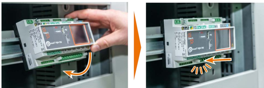
Rys. 4. Montaż analizatora na szynie DIN EN 60715 35 mm.
